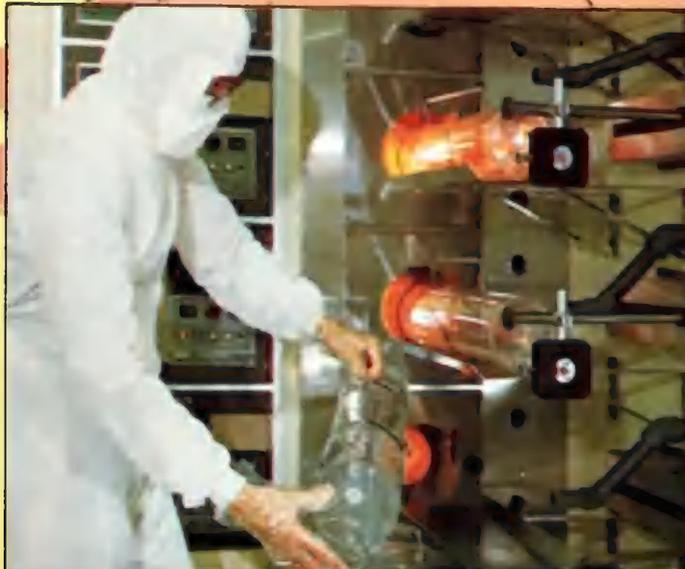
Bild links: Im Diffusionsofen werden die Siliziumschleiben gezielt verunreinigt.
